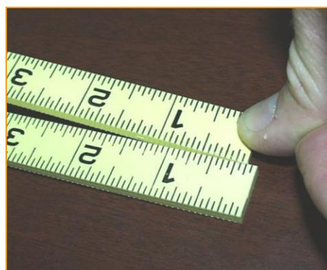
Este movimiento nos puede parecer insignificante, pero si se mueve el soporte solo 1 mm en 2 m, se levanta el recubrimiento rígido colocado sobre este soporte hasta 2 cm en su centro
